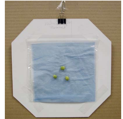
Visor de semillas opcional completo. Montaje realizado utilizando cartón, cartón, pinza para papel y pinza para carpeta
